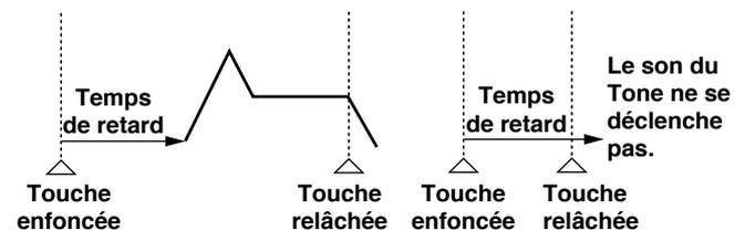
**PLAYMATE :** Si au minimum 2 secondes s'écoulent avant que la touche suivante ne soit enfoncée, le Tone se déclenche une fois le temps de retard écoulé. Si cet intervalle est inférieur à 2 secondes, il devient le temps de retard (Time) au bout duquel le Tone se déclenche.
