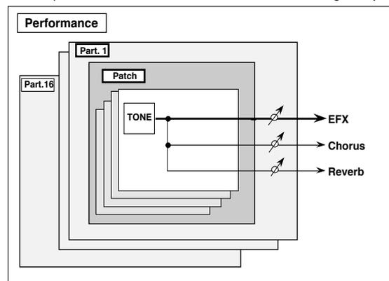
Fig.2 – Paramètre Output Assign réglé sur "PATCH" en mode Performance (l'affectation aux bus d'effets des Tones est alors prise en compte)
